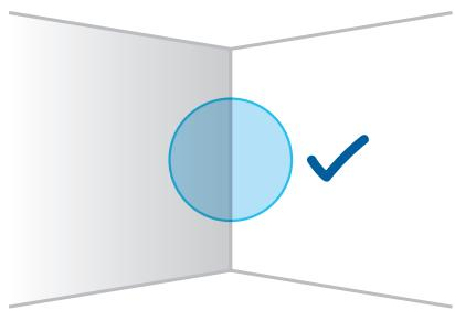
Wählen Sie die richtige Position für die Montage des Eckregals. Vergewissern Sie sich vor dem Anbohren der Wand, dass sich an der gewählten Stelle keine Stromleitungen oder Rohre befinden.
