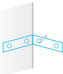
Appuyer le gabarit (E - fourni) sur les lignes horizontales tracées et, en exploitant les trous de celui-ci, marquer au crayon les 4 points (2 pour chaque ligne tracée) où les trous d'ancrage de l'étagère seront effectués.
