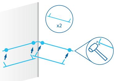
Prendre les deux supports en acier (A - fourni) et les insérer dans les bouchons sous pression, en utilisant un marteau en caoutchouc.
