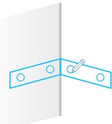
Appoggiare la dima (E - in dotazione) sulle linee orizzontali tracciate e, sfruttando i buchi della stessa, segnare con la matita i 4 punti (2 per ogni linea tracciata) in cui verranno eseguiti i fori di ancoraggio della mensola.
