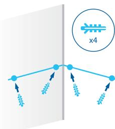
Una volta eseguiti i fori, inserire al loro interno i tappi a pressione (D - in dotazione).
