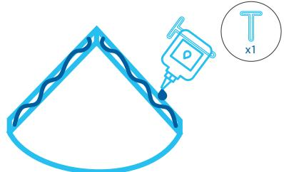
Retirer l'étagère des supports et appliquer le colle de scellement (C - fourni) dans les fentes de l'étagère, en s'aider, si nécessaire, de la pince (F - fournie) pour pincer le tube. En cas de positionnement dans la cabine de douche ou dans des environnements en contact avec l'eau, assurez-vous de sceller tout le périmètre avec du silicone.
