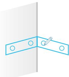
Legen Sie die mitgelieferte Schablone (E) auf die markierten waagrechten Linien und markieren Sie unter Nutzung der in der Schablone ausgebildeten Löcher mit dem Bleistift die 4 Punkte (2 pro Linie) zum Bohren der Löcher für die Befestigung des Eckregals.
