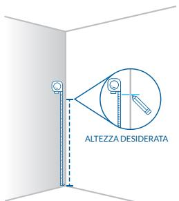
Determinare l'altezza da terra alla quale si vuole fissare la mensola e segnare con la matita il punto corrispondente su entrambi i lati della parete in prossimità dell'angolo.
