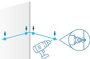
À l'aide de la perceuse avec une pointe de 8 mm, effectuer les 4 trous au niveau des 4 points marqués au crayon.
