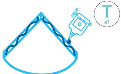
Estrarre la mensola dalle staffette e applicare l'adesivo sigillante (C - in dotazione) nelle fessure della mensola, aiutandosi, se necessario, con la pinza (F - in dotazione) per spremere il tubetto. In caso di posizionamento in box doccia o in ambienti a contatto con l'acqua, assicurarsi di sigillare con il silicone tutto il perimetro.
