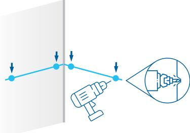
Benutzen Sie einen 8-mm-Bohrer, um die 4 Löcher an den 4 markierten Stellen zu bohren.
