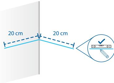
Une fois la hauteur souhaitée identifiée, à l'aide d'un niveau, tracez horizontalement une ligne d'environ 20 cm sur les deux murs, en partant du coin vers l'extérieur.
