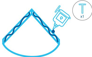
Nehmen Sie das Eckregal von den Stahlbügeln und verfügen Sie die Schlitzte des Eckregals mit dem mitgelieferten Dichtungskleber (C), verwenden Sie bei Bedarf die Tubenpresse (F). Bei der Befestigung in einer Duschablage vergewissern Sie sich, dass der gesamte Umfang des Regals mit Silikon verfügt wird.
