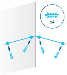
Nachdem Sie die Löcher gebohrt haben, setzen Sie die mitgelieferten Dübel (D) in die Löcher ein.
