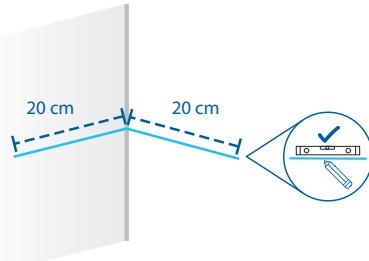
Nachdem Sie die gewünschte Höhe ermittelt haben, ziehen Sie mit Hilfe einer Wasserwaage an beiden Wänden eine zirka 20 cm lange waagrechte Linie von der Ecke nach außen.
